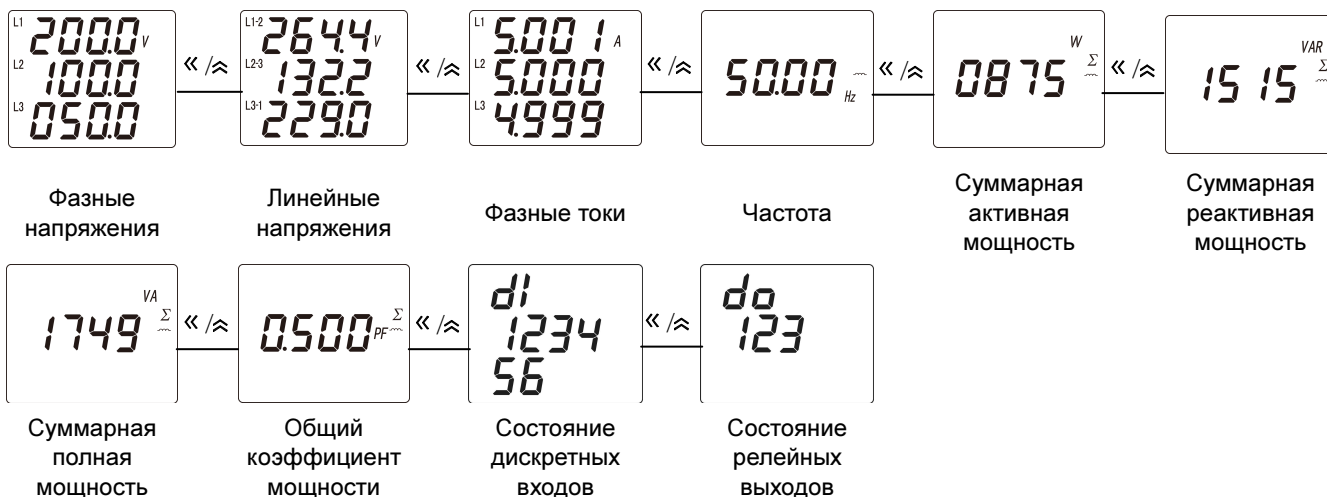
Рисунок 4.11 – Индикация показаний на приборе исполнения на DIN-рейку с ЖК-индикатором, дискретными входами и релейными выходами
