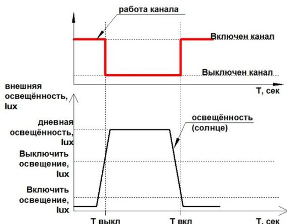
Для работы по солнечному свету можно использовать настройки по умолчанию - 100 и 300 lux для включения и выключения соответственно. Рекомендуется использовать датчик с верхним пределом от 400 до 1000 lux. При уставках выше этих, канал может срабатывать при сильной облачности и небольших солнечных затмениях.
