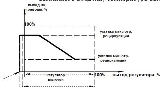
Рис. 7 Зависимость положения приводов от работы регулятора рециркуляции.
