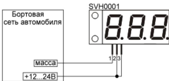
Пример включения модуля SVH0001 с модулем регулируемого стабилизатора
