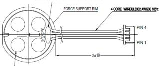
THE PUMP OF RUBBER SHOULD BE FREE FROM PRESS & SCRATCH. THE HIGHNESS NO MORE THAN 1.0mm AGAINST SUPPORT SURFACE OF AL HOUSING.
