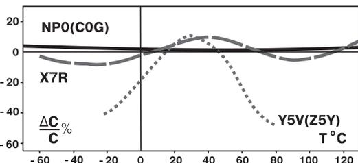
**NPO(C0G)** - используется в прецизионных цепях, в рабочем диапазоне емкость практически не зависит от температуры, времени, напряжения и частоты.
