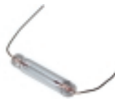
Лампа с осевой нитью накаливания 5x22 9V 100mA
