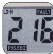
Пофазное отображение напряжений
