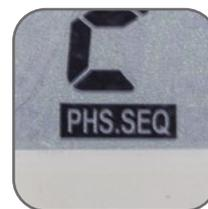
Отображение текущей неисправности на дисплее
