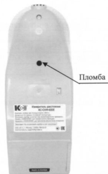
Рисунок 4 - Схема пломбировки от несанкционированного доступа измерителей КС-СНМ-600Е
