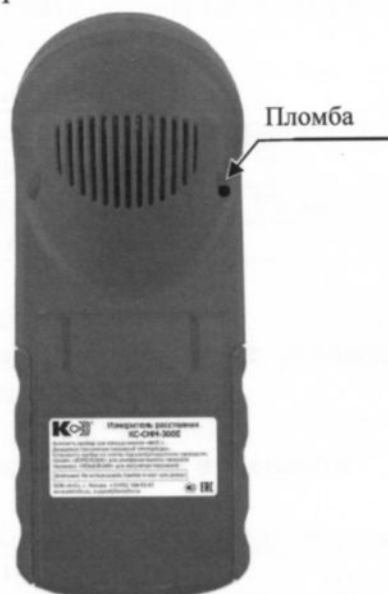
Рисунок 3 - Схема пломбировки от несанкционированного доступа измерителей КС-СНМ-600А
