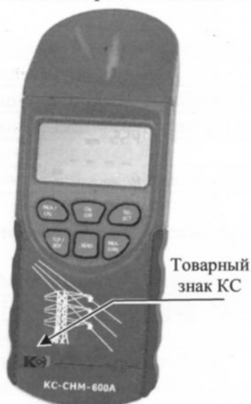
Рисунок 1 - Общий вид измерителя КС-СНМ-600А с указанием места расположения товарного знака КС
