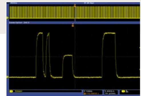
Поскольку осциллограф может сохранять лишь ограниченное число выборок, временное окно захвата осциллограммы обратно пропорционально частоте дискретизации осциллографа.
