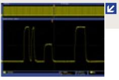
Длина записи – это число точек, из которых состоит зарегистрированная осциллограмма. Осциллограф имеет ограниченный объем памяти для записи выборок, поэтому чем больше объем памяти, тем большую длину записи можно получить.
