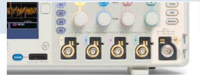
Комбинированные осциллографы (MDO) не только предлагают аналоговые и цифровые каналы, как и осциллографы смешанных сигналов (MSO), но и имеют отдельный РЧ вход, сигнал которого можно анализировать в частотной области.
