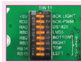
Рисунок 21-3: Включен SW11.4 DIP-переключатель
