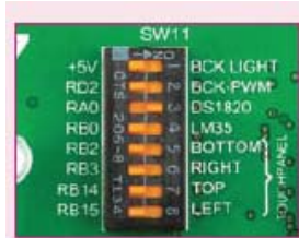
Рисунок 20-3: Включен SW11.3 DIP-переключатель
