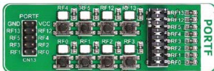
Рисунок 6-1: группа входа/ выхода содержит выходной разъем порта, DIP-переключатель трех состояний, кнопки и светодиоды, расположенные все в одном месте
