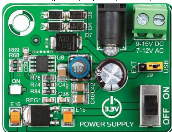
Рисунок 3-1: Блок питания платы EasyPIC Fusion v7
