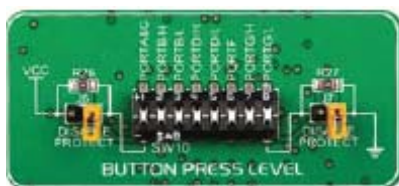
Рисунок 6-5: Кнопка нажатия уровня DIP переключателя (с тремя состояниями)
