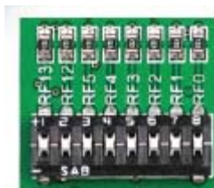
Рисунок 6-2: DIP-переключатель с тремя состояниями на PORTF
