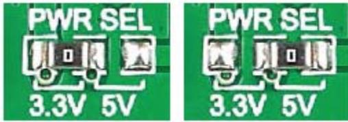
Существует одна нуль-ом SMD перемычка J1, которая используется для выбора того, какой используется источник питания 3.3В или 5В. Перемычка J1 припаяна в положении 3,3В по умолчанию.
