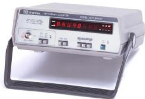
Частотомер электронно-счётный GFC-8010H
