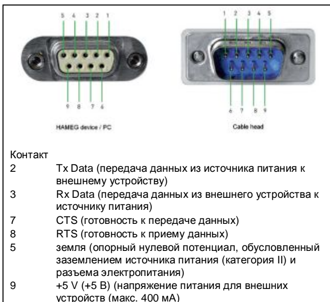
Рис. 6.1 – Назначение контактов интерфейса RS-232
