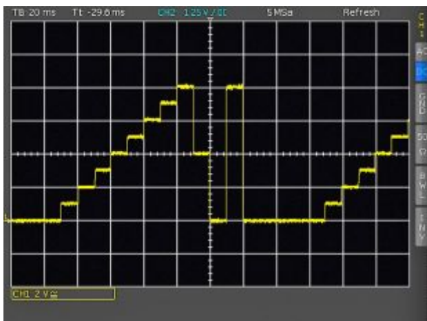
Рис. 3.2 – Произвольный шаг по напряжению
