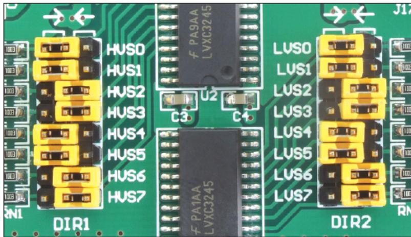
Переключки HVS1, HVS4 и HVS5, принадлежащие к группе **DIR1**, а также переключки LVS0, LVS1, LVS4 и LVS5, принадлежащие к группе **DIR2** располагаются таким образом, чтобы позволить регулировать сигнал напряжения от **5В до 3,3В**. Кроме того, переключки HVS2, HVS3, HVS6 и HVS7, принадлежащие группе **DIR1**, а также переключки LVS2, LVS3, LVS6 и LVS7, принадлежащие группе **DIR2** располагаются таким образом, чтобы позволить регулировать сигнал напряжения от **3,3В до 5В**.
