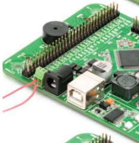
Лабораторный блок питания подключен к винтовым клеммам
