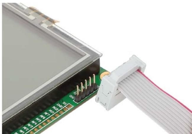
Рисунок 7-2: Подключение mikroProg к SmartGLCD 128x240 через 1x5 male контактную площадку
