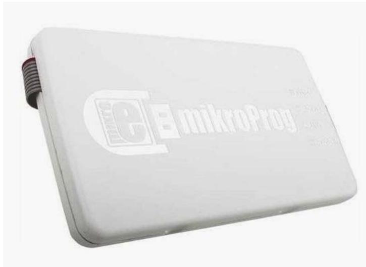
mikroProg for PIC – это быстрый и надежный программатор с ICD поддержкой. Специально разработанная прошивка позволяет программировать все микроконтроллеры фирмы Microchip: PIC, DSPIC и PIC32. С mikroProg одна прошивка подходит для всех поддерживаемых архитектур. Загрузив последнюю версию программного обеспечения mikroProg Suite, ваш программатор будет готов для программирования новых устройств.
