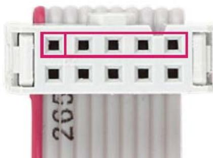
Рисунок 7-1: Используйте только переднюю сторону для программирования
