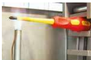
Test wysokotemperaturowy, ognioodporność. High temperature test, flame retardant test.
