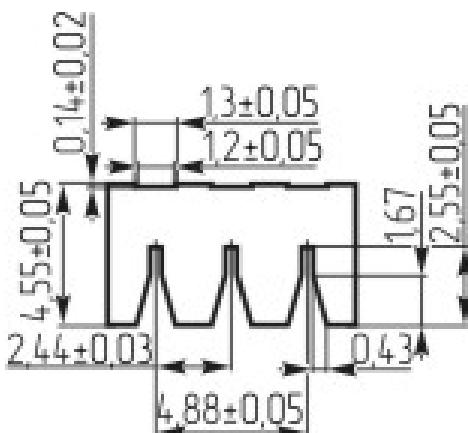
Устанавливайте кварцевые резонаторы правильно, используя прокладку для вертикального монтажа и клипсы для горизонтального.
