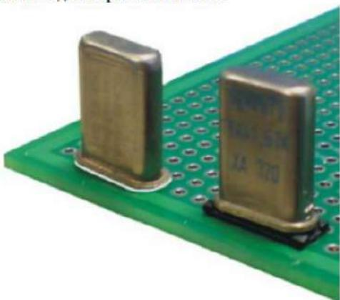
При вертикальном монтаже кварцевый резонатор должен быть установлен на плату через изолирующую прокладку максимально плотно для исключения разрушения стеклотаблетки в корпусе при ударах и вибрациях.
