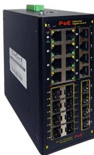
**CO-PF-8GP4G12SPF-P511** - Промышленный управляемый PoE коммутатор для CCTV. 8xRJ45 PoE 10/100/1000 до 30W, 4xRJ45 Uplink 10/100/1000 и 12xSFP 100/1000. Производительность 48Gbps /35.71Mpps. Store-And-Forward, Auto-negotiation, Flow Control, Full duplex. Бюджет PoE до 240W. Резервируемое питание 48~57VDC, потребление до 260W. Температурный диапазон -40°C ~ +80°C, IP40, вес 1200г, размеры 165x148x68.5мм. Металлический кожух, крепление на DIN рейку в комплекте.
