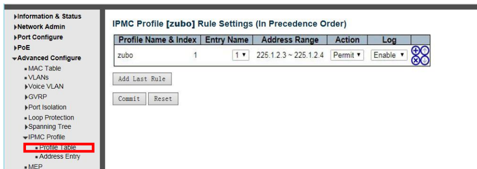
Рисунок 5-5-2 Экран настройки правила фильтрации для определенного профиля IPMC.
