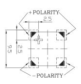
RECOMMENDED PCB LAYOUT (Top View)
