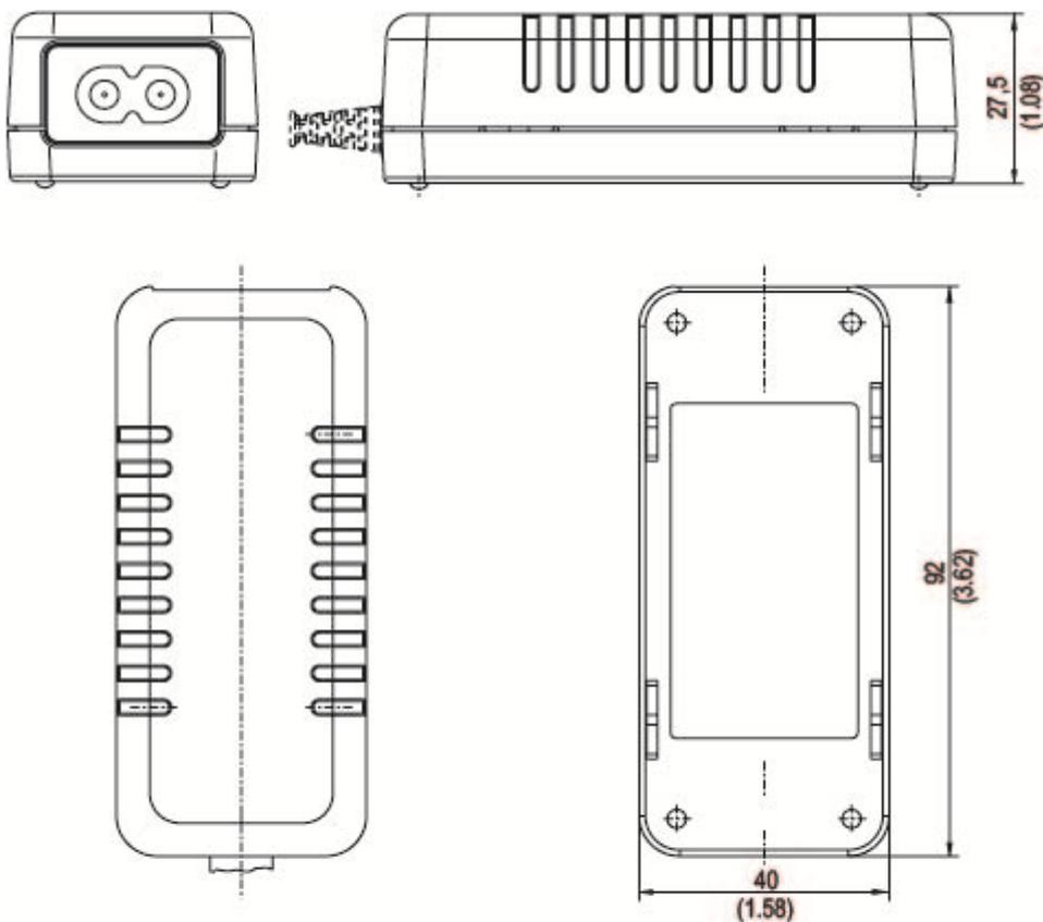
Alle Abmessungen in Millimeter (Inch), Abweichung ± 0,5 (0.02)
