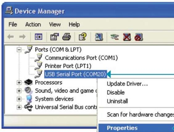
Во вкладке *Диспетчер устройств* выберите **COM порт**, который используется для связи с AT Mini платой (в данном случае COM20)
