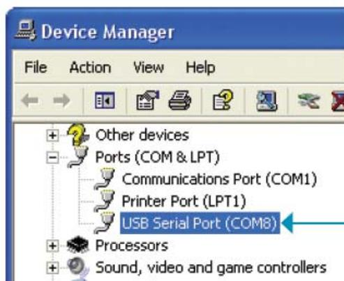
В диспетчере устройств на вашем ПК найдите COM порт, на который можно подключить отладочную систему
