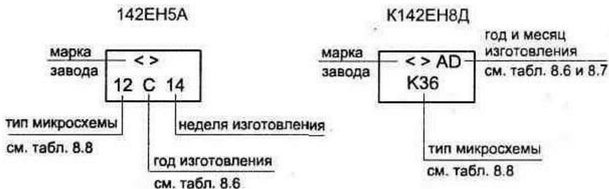
Микросхемы стабилизаторов с приставкой КР вместо К имеют те же параметры и отличаются только конструкцией корпуса, см. рисунки. При маркировке этих микросхем часто используют укороченное обозначение, например вместо КР142EH5А наносят КРЕH5А.
