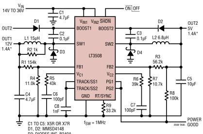
D3: DIODES INC. B240A D4: DIODES INC. B140
