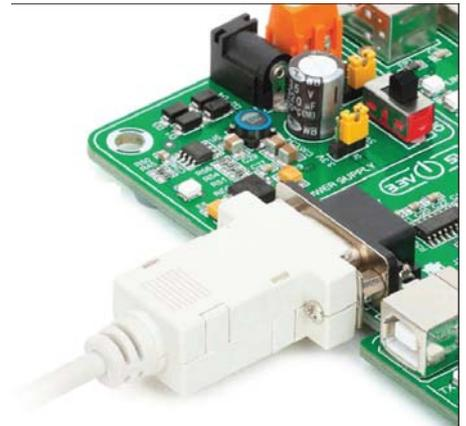
RS-232 последовательная связь осуществляется через 9-контактный SUB-D разъем и UART модуль микроконтроллера. Необходимо установить связь между RX и TX линиями на SUB-D разъем и теми же выводами на микроконтроллер с использованием DIP-переключателей. Поскольку уровни напряжения связи RS-232 отличаются от логических уровней микроконтроллера, необходимо использовать схему RS-232 приемопередатчика, например, MAX3232, как показано на рисунке.
