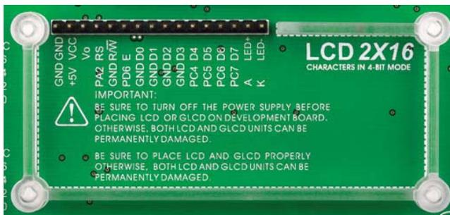
Жидкокристаллические дисплеи или ЖК-дисплеи популярны для конечного пользователя электронного устройства. Плата EasyAVR™ V7 снабжена разъемом и необходимым интерфейсом для поддержки ЖК-дисплеев 2x16 характеристики в 4-битном режиме. Этот тип дисплея имеет в два ряда, состоящего из 16 полей символов. Каждое поле
